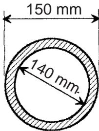
$$\begin{aligned} \text{Épaisseur de la paroi} &= \frac{150 - 140}{2} \\ \text{du conduit} &= 5 \text{ mm} \end{aligned}$$
