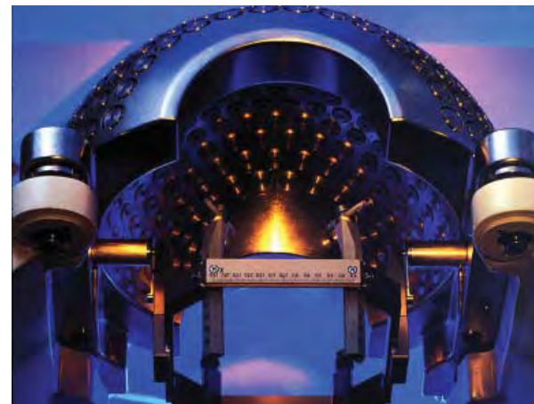
Figure 4-10 La photo ci-dessus est celle d'un collimateur. Le collimateur a deux fonctions : maintenir en position la tête du patient et diriger les rayons gamma à travers les petits orifices pratiqués sur la surface de la demi-sphère.
