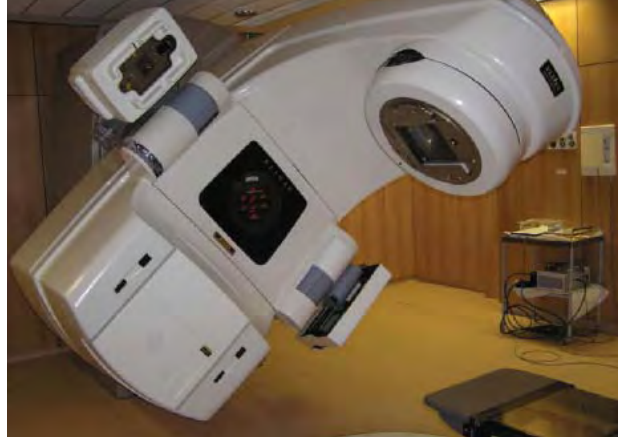
Figure 4-8 Photo de l'appareil de traitement par accélérateur linéaire Clinac. Note que la source de faisceaux de haute énergie est conçue pour effectuer des rotations autour du patient.
